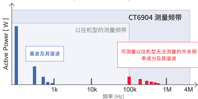
电流传感器测量平带和逆变器次级侧的有功功率频谱 (为 100 kHz 开关时)
