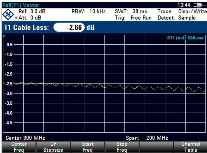
单端口电缆损耗测量
