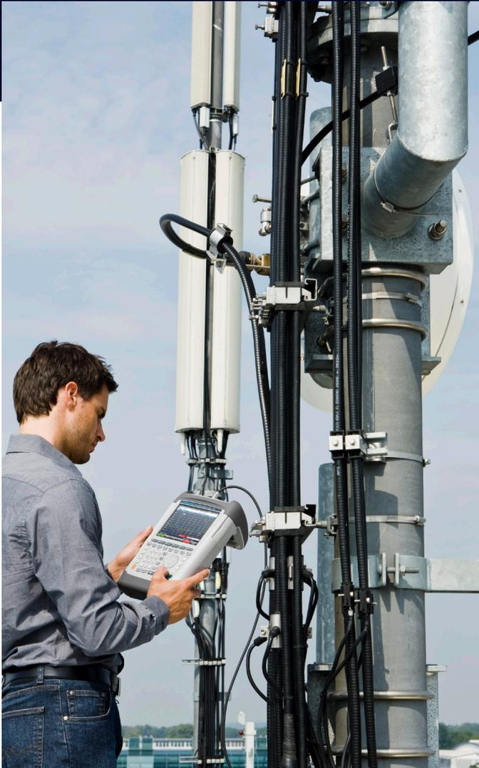
使用 R&S®ZVH 对移动无线电天线系统执行故障点距离测量
