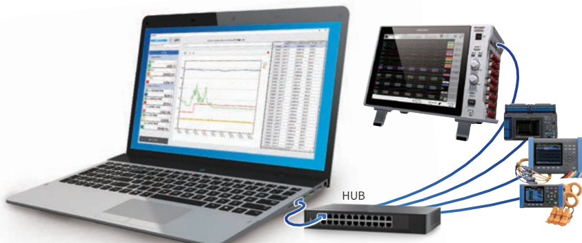
通过 LAN 连接各个测量仪器
