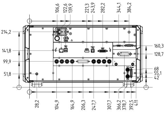
Rear view of the R&S<sup>®</sup>ZNBT8, R&S<sup>®</sup>ZNBT20, R&S<sup>®</sup>ZNBT26 and R&S<sup>®</sup>ZNBT40
